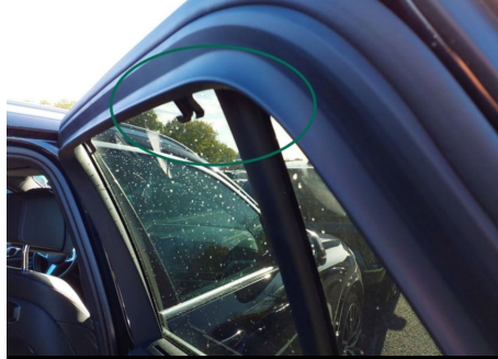
Support de pare-soleil / Avant Droit / Cassé
