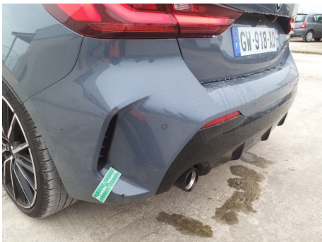
Pare-chocs / Arrière / Enfoncement
