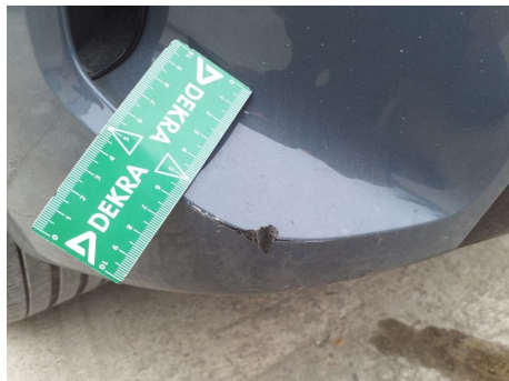
Pare-chocs / Arrière / Enfoncement
